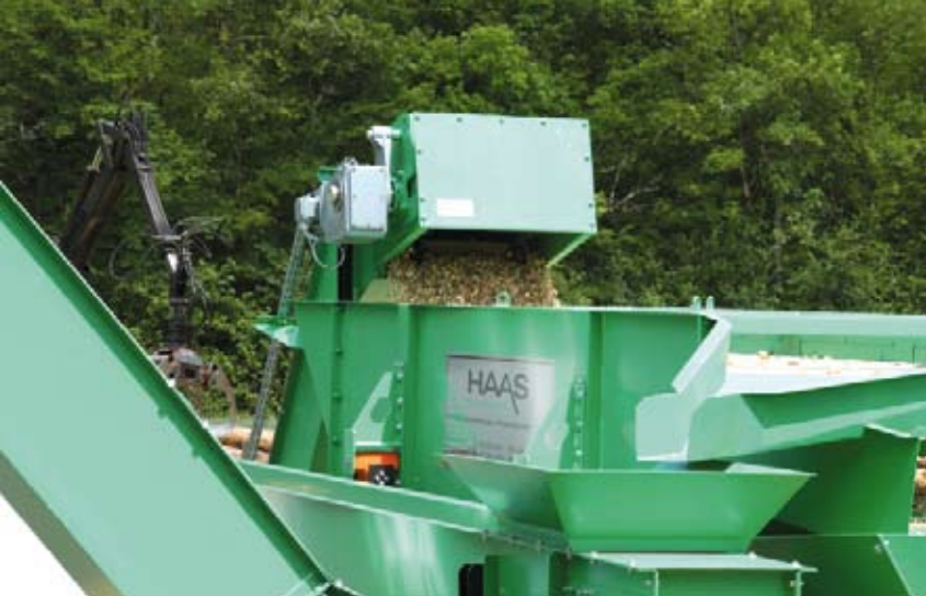
Un convoyeur à chaînes achemine les broyats vers un crible à tamis vibrant Haas type HPS qui sépare le produit broyé en 3 fractions.
